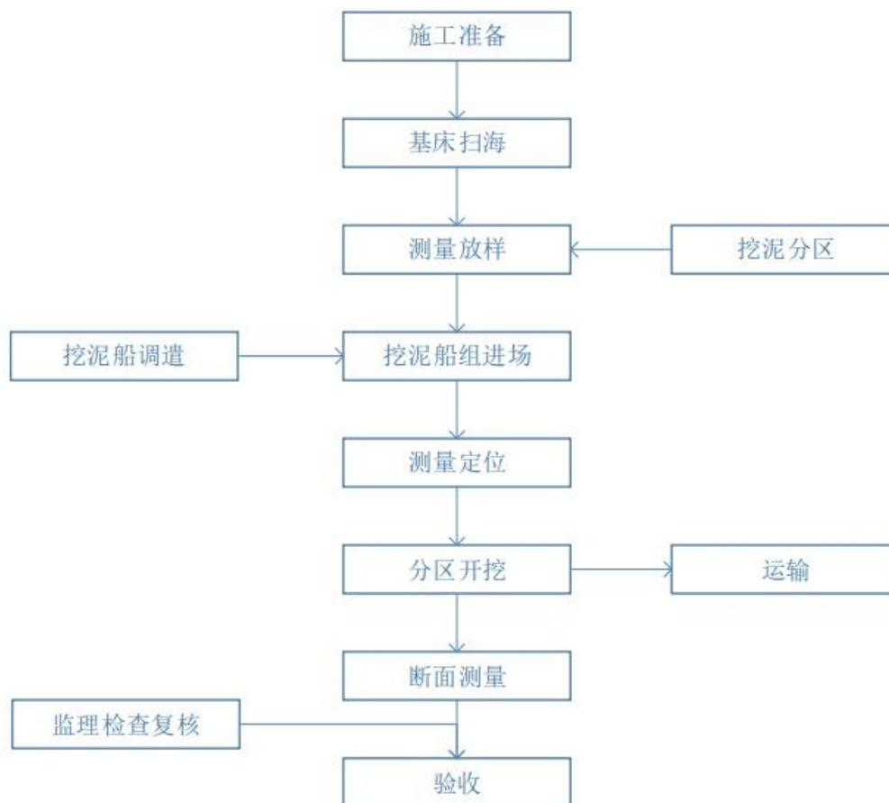
图 2-11 疏浚施工工艺流程图
